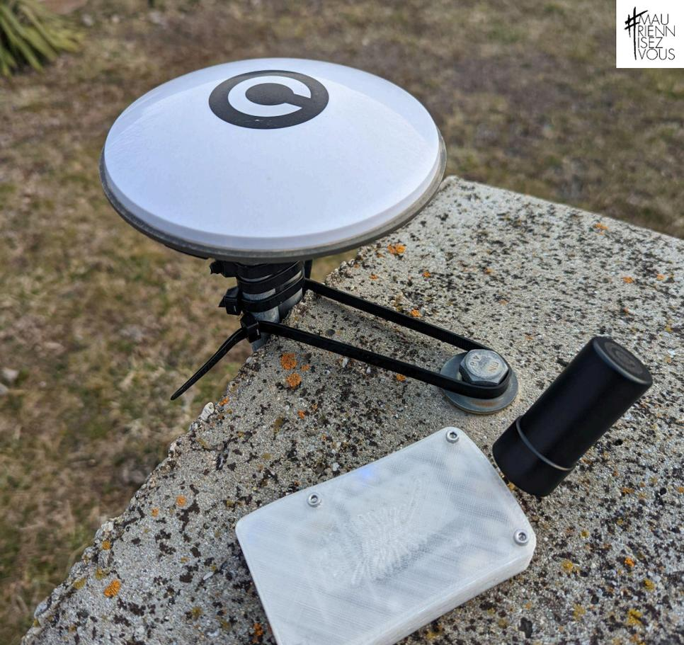
**Impression 3D et fabrication du "Rover" Centipede**
